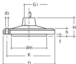
**Разделительная мембрана с фланцевым присоединением DRM-R-624 Ø 100 мм**
