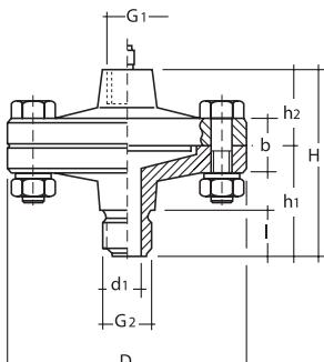
**Разделительная мембрана DRM-R-625 с присоединением G 1/2 и увеличенным отверстием, Ø 10 мм**
