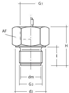
Диапазон измерений: 0 - 6 бар до 0 - 1600 бар (размер датчиков давления – тоже меньше)
