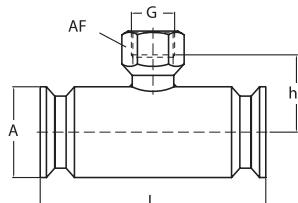
**Встроенная разделительная мембрана DRM-R-502 с капиллярным присоединением ISO 2852 для прямого монтажа**
