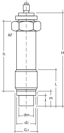
**Разделительная мембрана DRM-R-620/1, Ø 18 мм, вращающийся, длинный с гайкой для присоединения капиллярной трубы**
