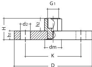
**Разделительная мембрана с фланцевым присоединением DRM-R-634 / 635 к ANSI B16.5 со встроенной мембраной**
