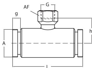
**Встроенная разделительная мембрана DRM-R-500 / 501, стерильное присоединение ISO, для монтажа напрямую и с капиллярной трубкой**
