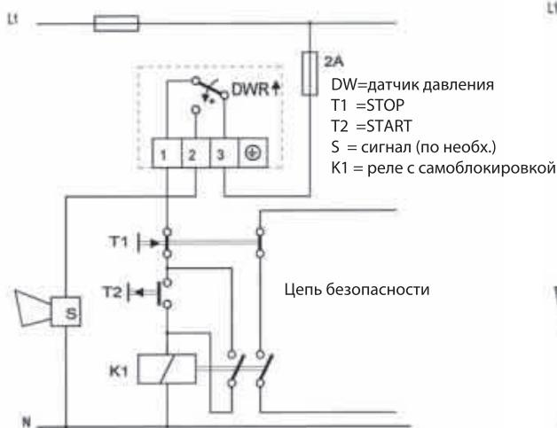
При использовании цепи блокировки, изображённой выше, требования в соответствии с DIN 57 116 / VDE 0116 выполняются, если электрооборудование, такое как
