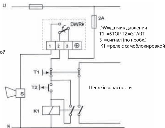
замыкатели или реле схемы внешней блокировки соответствуют VDE 0660 или VDE 0435 соответственно.
